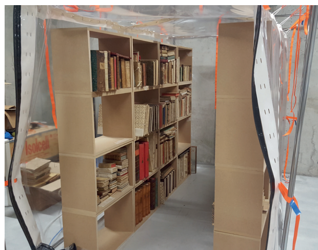
Figura 5 - Trattamento anossico in camera climatica
