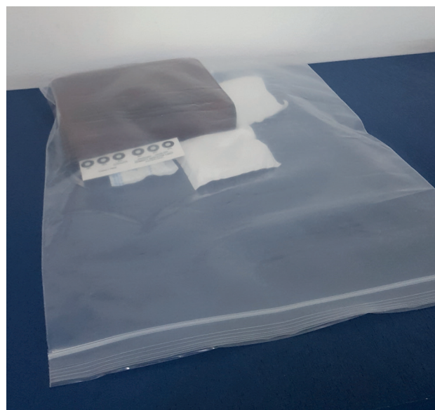
Figura 6 - Trattamento effettuato con assorbitori di ossigeno su un volume con coperta in cuoio
