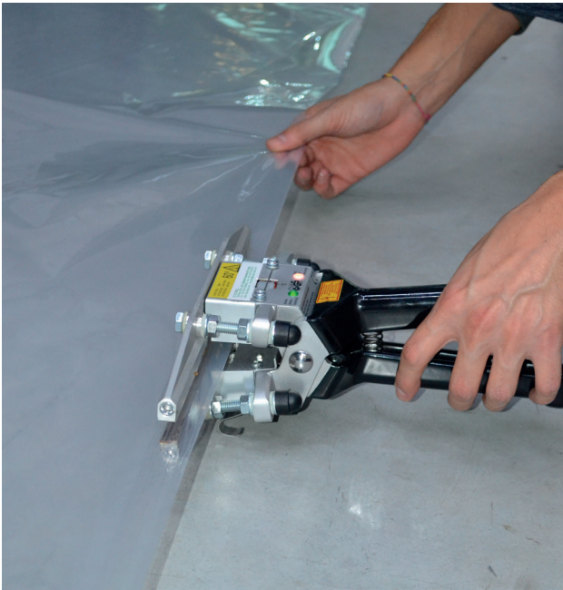
Figura 4 - La saldatura con pinza termica
